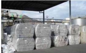
セメント用燃料（廃プラスチック・廃油）
