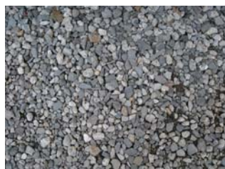
砂利（建設廃材リサイクル）
