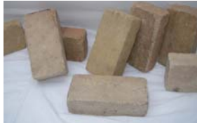
耐火レンガ、路盤材（炉廃材）
